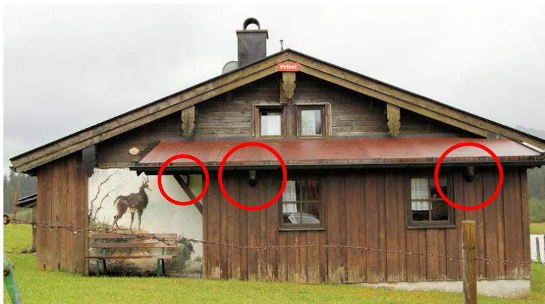
◀ Wand-Leuchten, die in Richtung West abstrahlen. Bestückt mit Glühbirne (40 Watt) und zwei Halogen-Lampen (30 Watt). Schaltung manuell. Die links an der Tür hat ein milchiges Gehäuse, die beiden rechts sind aus Klarglas. Alle sind weit genug unter dem Vordach (ca. 1m Tiefe), so dass die Abstrahlung nur maximal in die Waagrechte erfolgt.
