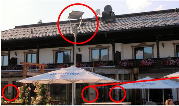
SSO-Seite: zusätzlich „Ambiente“-Beleuchtung (gesamt 8 Stück), montiert auf den Holzbalken. Strahlen warmweiß nach oben/unten in Richtung Balken. Und ein LED-Reflektor, der ab und an bei Veranstaltungen genutzt wird.
