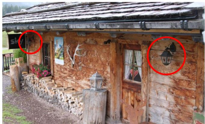
Auf der NO-Seite sind unter dem ca 1m breiten Dach 2 Laternen montiert. Leuchtmittel sind jeweils 30 Watt Halogen-Lampen (mit Bewegungsmelder).
