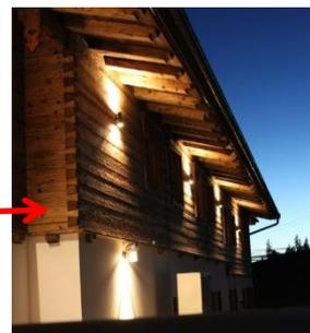
Blick aus Richtung NNO: die Wandleuchten sind recht gut geschirmt, aber alle etwas zu hell bzw. in Summe sind sie evtl. etwas zu hell (dimmen). Vorteil: alle unteren Wand-Laternen sind mit vollgeschirmten warmweißen LED-Reflektorlampen ausgerüstet.
