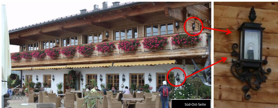
Von diesen Balkon-Leuchten (Wand-Laternen), die mit 30 Watt Halogen, teils auch mit 42/46 Watt Halogen-Lampen und einigen 11 Watt Energiespar-Lampen (also bis zu 600 Lumen) ausgestattet sind, sind insgesamt an diesem Hotel 41 Stück montiert (alle werden gemeinsam manuell geschaltet).
