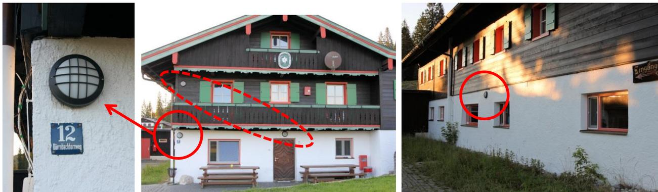
6 solche ▲Wandleuchten (2700°K, 9 u.12 Watt Energiesparlampen) sind am Haus. Gestrichelter Kreis: die beiden sind mit Dämmerungsschaltel gekoppelt.
